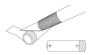
2. EASY utilise un contact supplémentaire sur le côté droit du compartiment de la batterie qui doit être en contact direct avec la gaine métallique exposée de cette batterie.
