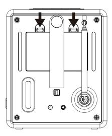
2. Insérez 6 piles alcalines AA / LR6 de 1,5 volt, en faisant attention à la polarité.
